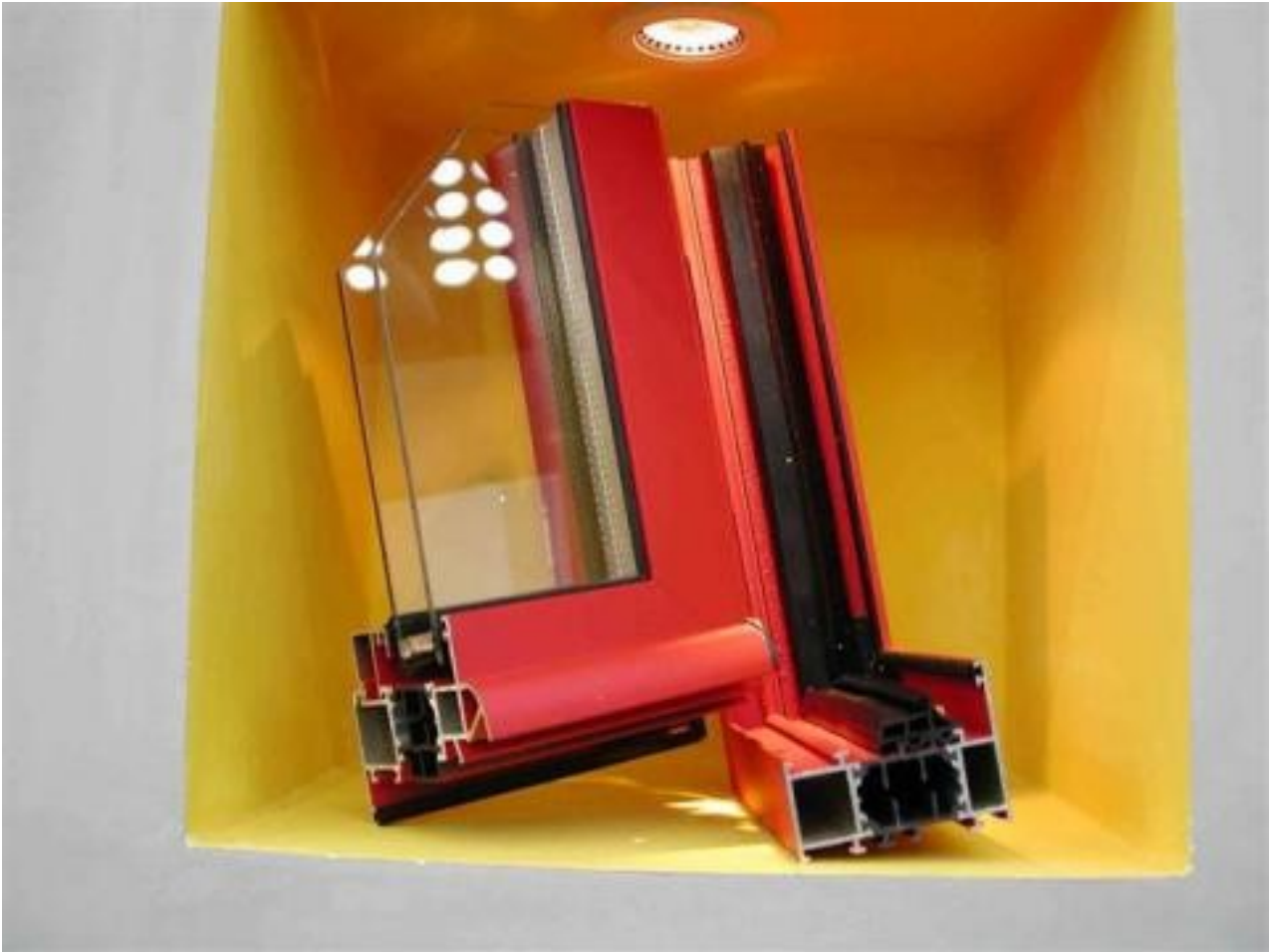
Ćošak prozora koji je napravljen od aluminijumskih profila sa termo-prekidom (spoljni i unutrašnji aluminijumski profili su crvene boje, srednji profil od tvrde plastike i zaptivne gume su crne boje)
